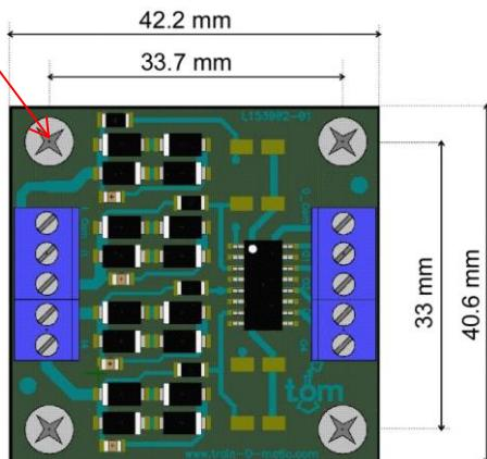
Diodele din circuitele de intrare suporta un current nominal de 1A in regim continuu, dar rezista la varfuri de currenti de 30A pe o durata de 8 milisecunde. In cazul unor scurtcircuite pe linie, circuitele de protectie din statiile digitale de comanda, sau din boostere decoupleaza tensiunea de iesire intr-un timp mai scurt de 8 milisecunde, astfel realizand protectia circuitelor de detectie BOD.
