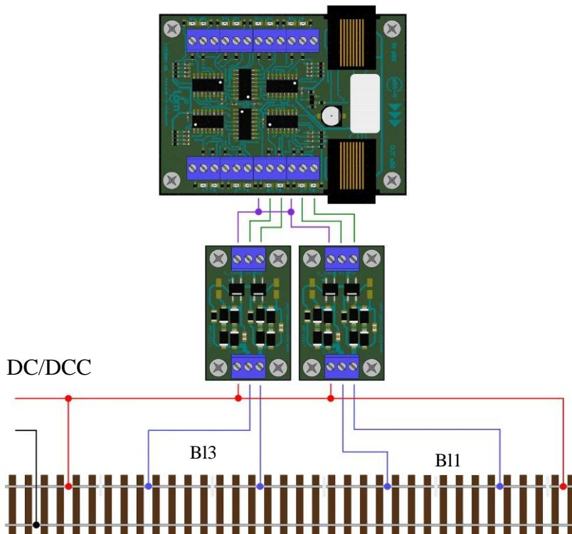
Exemplu de conexiune a unui modul BOD4 la un modul S88N
